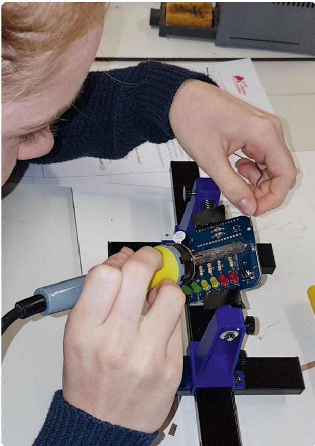
*Bestücken und Lötten der Erweiterungsplatine für den Arduino Nano*
