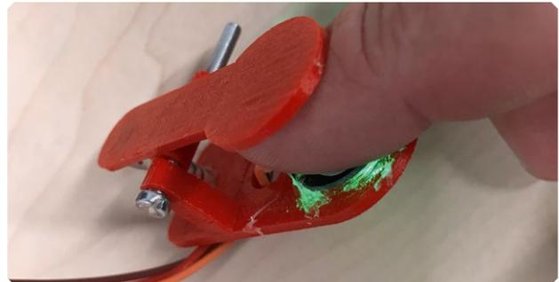
Einsatz des mit 3-D-Druckverfahren hergestellten Pulssensors
