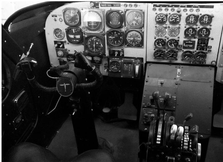
Blick in das Cockpit eines Verkehrsflugzeugs mit Steuerhorn
