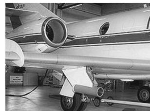
DLR-Forschungsflugzeug mit Partikelsonde am Tragflügel
