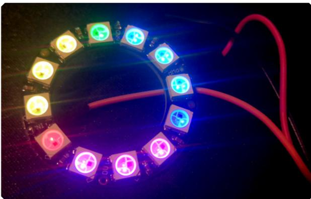
Der LED-Ring kann mittels Arduino-Programmierung in allen Regenbogenfarben leuchten
