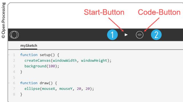
Die Programmierumgebung mit Beispielcode. Im oberen Bereich des Fensters befinden sich der Start- und der Code-Button
