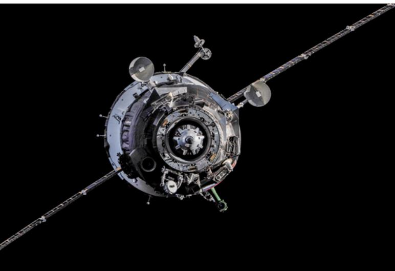
Ein *Soyuz*-Raumschiff im Anflug auf die *ISS*. Unten rechts auf der 5-Uhr-Position ragt (gut an der grünen Farbe erkennbar) das Periskop hervor. Das Bild des Periskops wird der Crew auf einen Monitor übertragen. Oben auf 11 und 2 Uhr befinden sich die Antennen des automatischen Dockingsystems. Vorne an der Spitze ist der Andock-Mechanismus zu sehen. Bild: NASA
