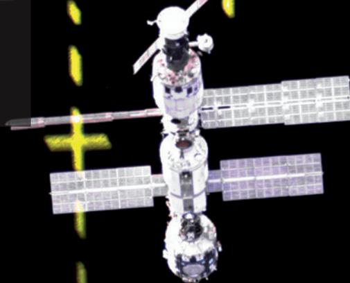
Die Raumstation im Visier des Dockingsystems. Das Bild wurde aus einem amerikanischen *Space Shuttle* aufgenommen. Aber auch die russischen *Sojus*-Raumschiffe verfügen über ein solches System, bei dem die Crew mit einem Periskop den Andockvorgang verfolgen kann. Bild: NASA
