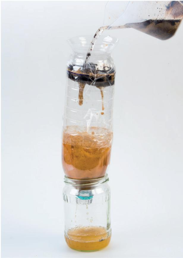
Die selbst gebaute Wasseraufbereitungsanlage.
