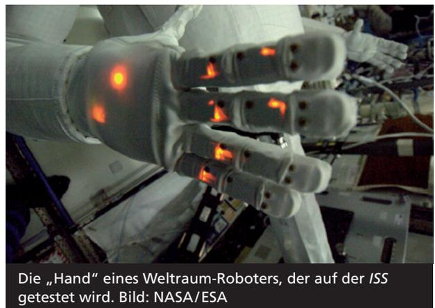
Die „Hand“ eines Weltraum-Roboters, der auf der ISS getestet wird. Bild: NASA/ESA
